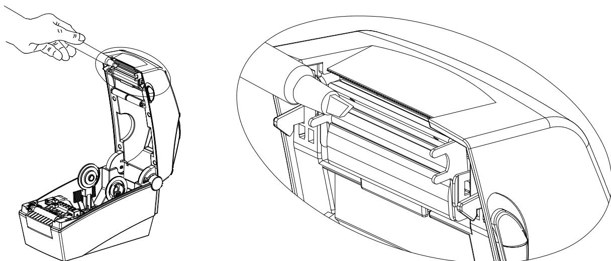
**6-2 Очистка датчиков, ролика-протяжчика и/или канала протяжки бумаги**
