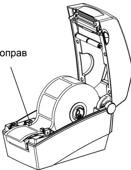
5) Закройте крышку отсека для бумажного рулона до щелчка.
