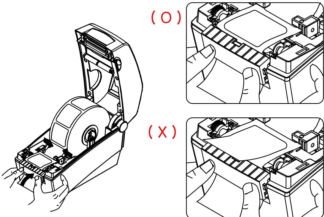
5) Закройте крышку отсека для бумажного рулона до щелчка.
