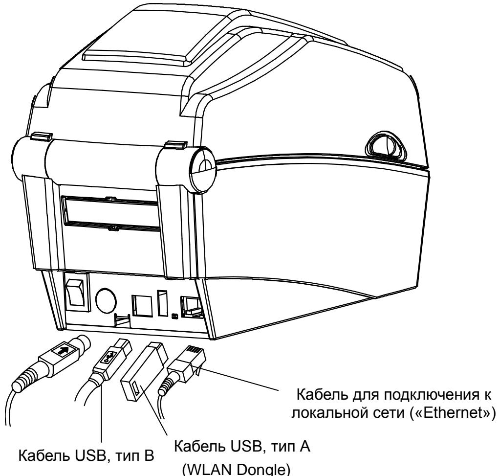
1) Выключите принтер кнопкой включения/выключения.
